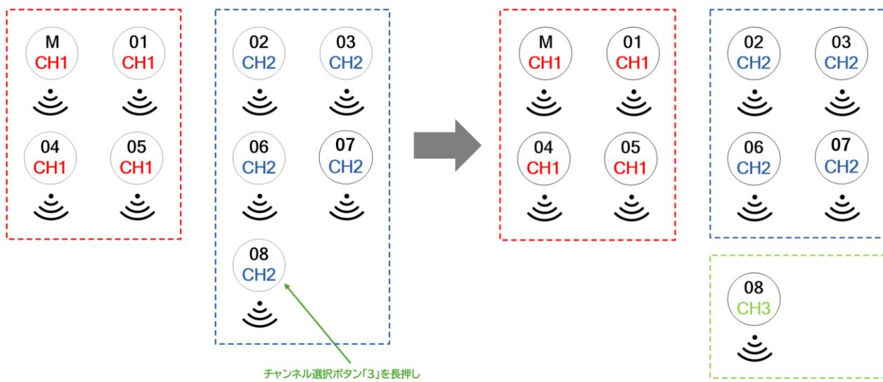
\*『チャンネル選択ボタンを使用して変更』の具体例(ID:08がチャンネル3からチャンネル A へ変更した場合)
